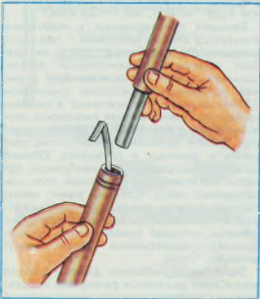
Рис. 7. Способ уплотнения штекерной стыковки колен с помощью кусочка пленки.
